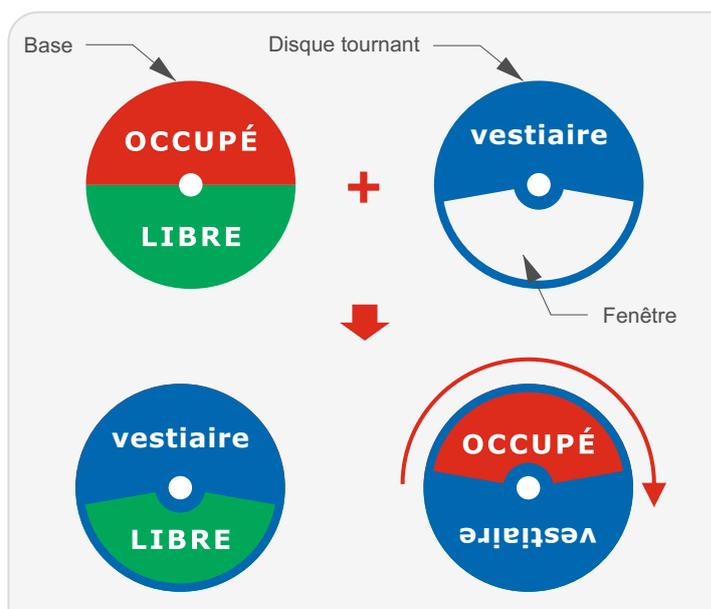
Schéma de principe pour un modèle « Vestiaire »
